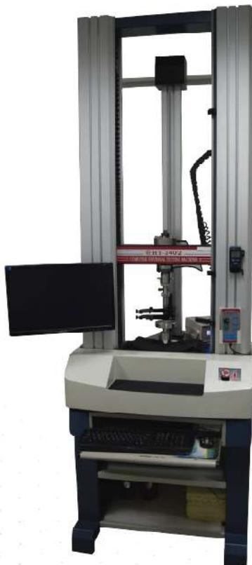
Equipo de prueba de materiales de alta precisión y alta estabilidad : capaz de realizar pruebas de tracción, compresión.
