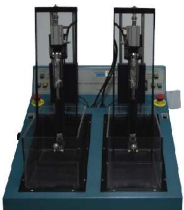
Ensayo dinámico para evaluar la resistencia del calzado a la penetración del agua. Esta máquina de estaciones gemelas replica la acción de caminar mientras que el calzado está sumergido en agua.
