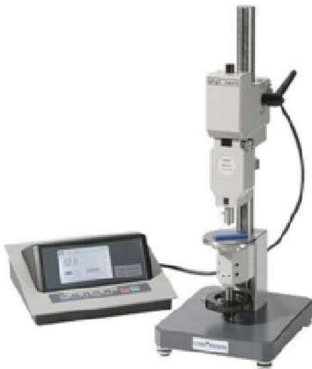
Determinación rápida de la dureza de superficies.
