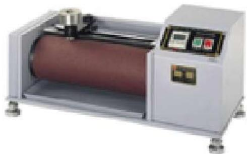
Determina la pérdida en masa por efecto de la abrasión permitiendo calcular la resistencia de suelas.
