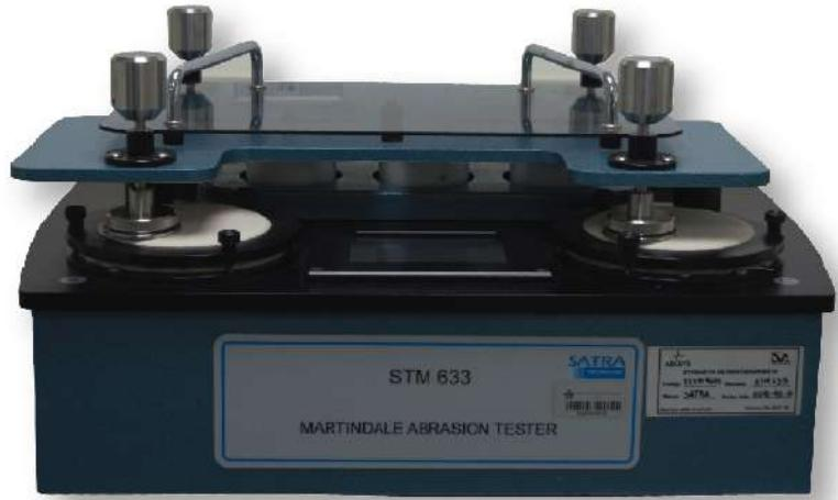
Determina la resistencia de un material a la abrasión en seco y en húmedo. Este método es aplicable principalmente a telas, tejidos recubiertos y cueros.
