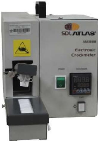
Prueba la transferencia de color de la superficie de un material textil a otro mediante un frote lineal en seco y en húmedo
